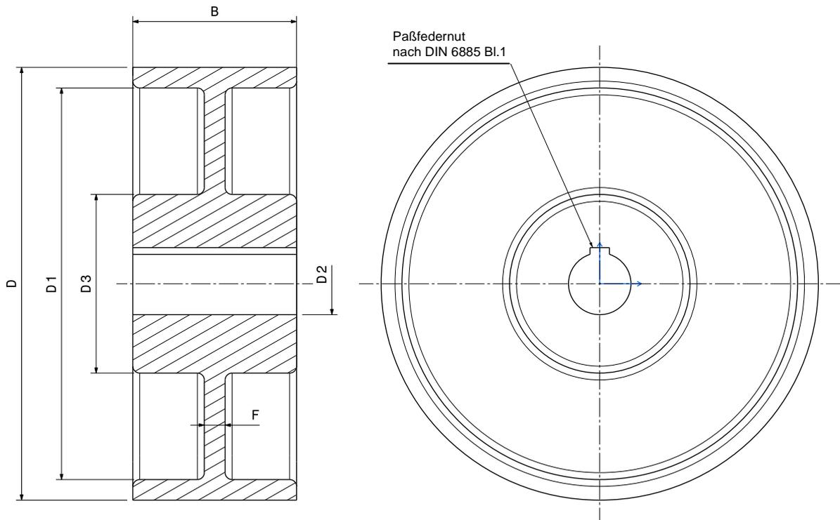
**Bei Lieferung** mit Fertigbohrung können die Bremstrommeln auf Wunsch dynamisch ausgewuchtet werden.
